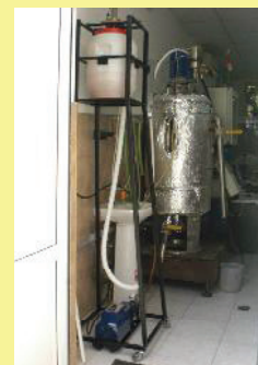
Фиг.14. Общ вид на подхранването с шнековата помпа
